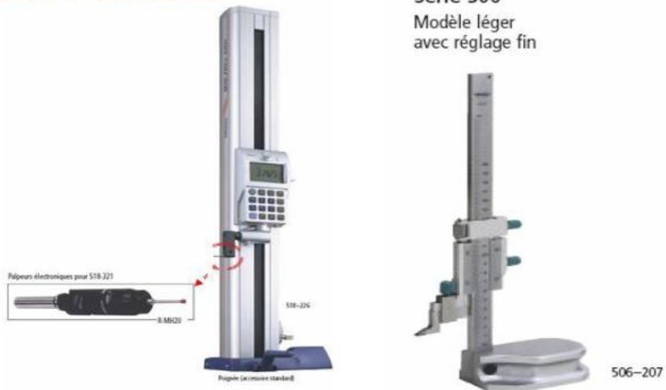
**Colonne de mesure et Trusquin**
